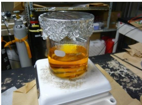
写真1 錯体重合法による酸化チタン基粉末合成
