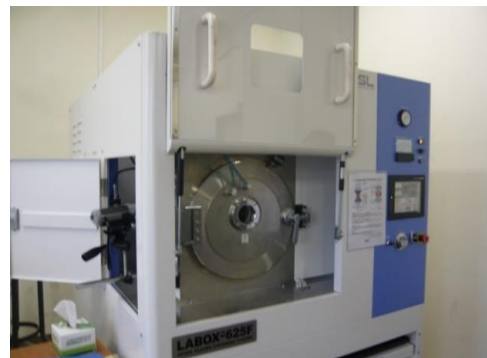
写真2 放電プラズマ焼結(SPS)装置の外観
